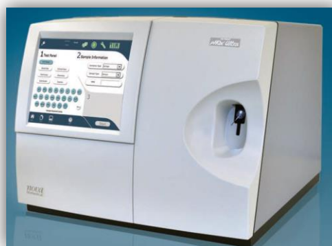
Nový přístroj firmy Nova Biomedical, Stat Profile® PhOx® Ultra™; měří celkem 20 parametrů, mezi nimi i Mg^{2+}
